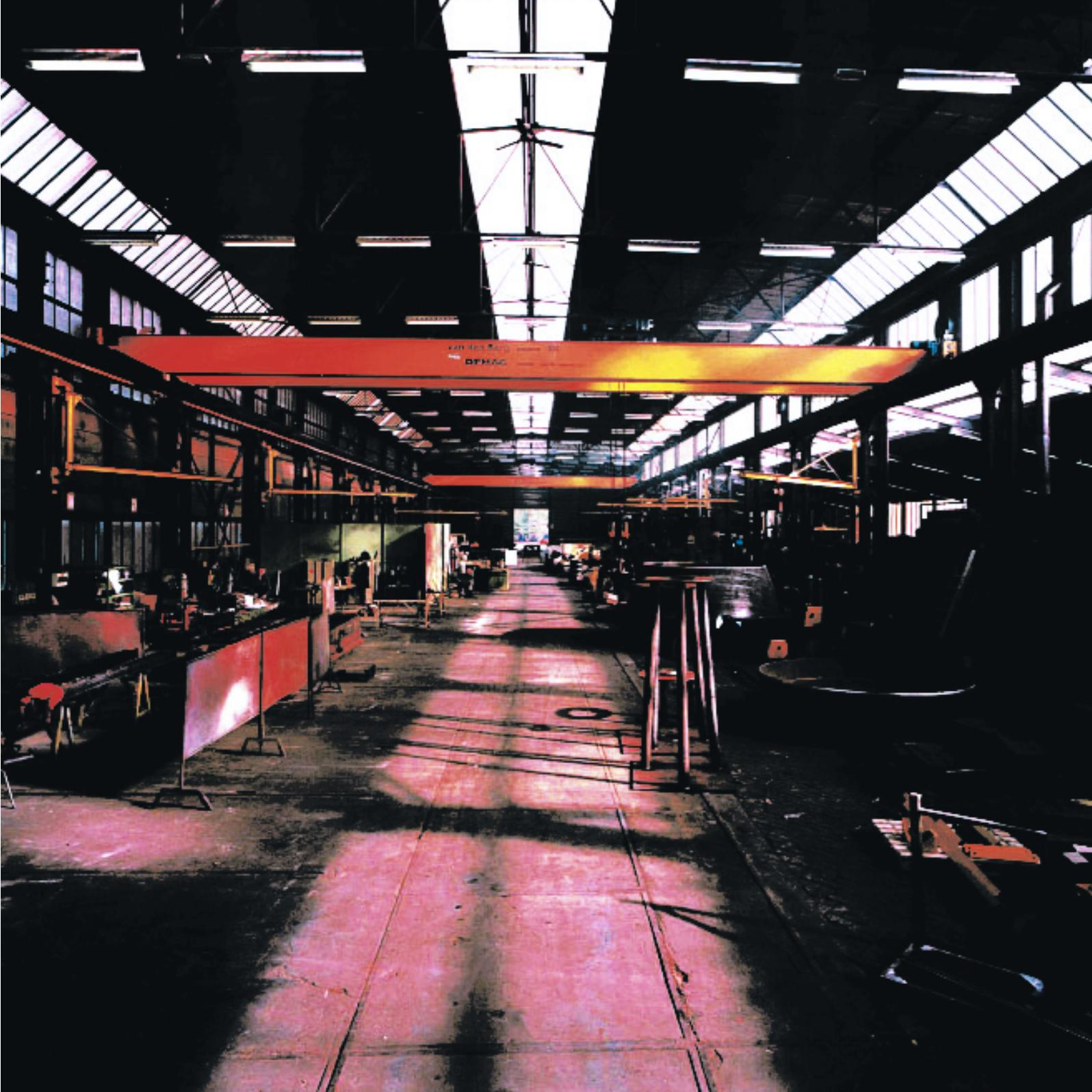
In Belgien ersetzte der GreenLight-Partner Beerse Metaalwerken die Standard-Hochdruck-Quecksilberlampen in seiner Werkstatt durch Leuchtstofflampen mit 26 mm Durchmesser und installierte darüber hinaus eine tageslichtabhängige Lichtregelung. In ihren Büros ersetzten sie die alten Leuchtstofflampen mit 38 mm Durchmesser durch moderne Lampen mit 26 mm Durchmesser und elektronischen Vorschaltgeräten.
